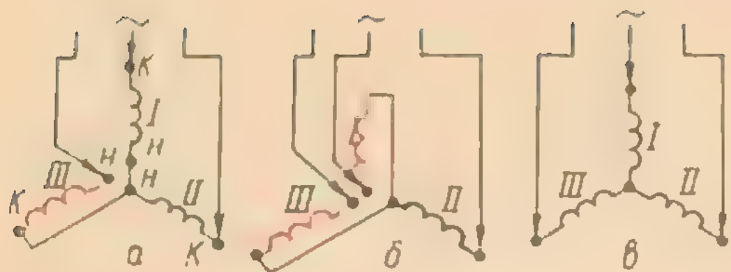
Рис. 17.7. Определение условных начал и концов обмоток методом подбора: а, б, в — варианты проб схемы «звезда».
