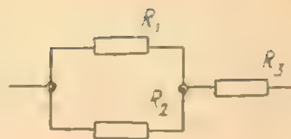
Рис. 2.5. Смешанное соединение резисторов.
