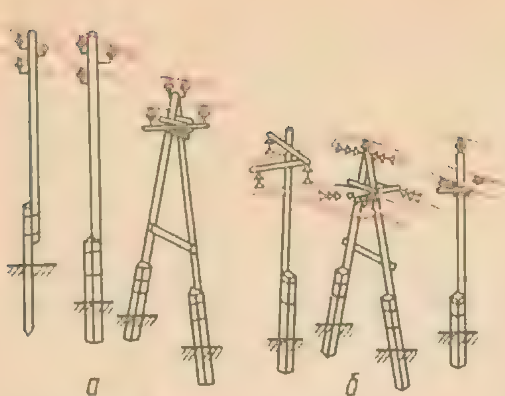
Рис. 15.6. Опоры высокого напряжения с железобетонными приставками:
