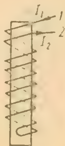
Рис. 5.9. Бифилярная намотка катушки.
