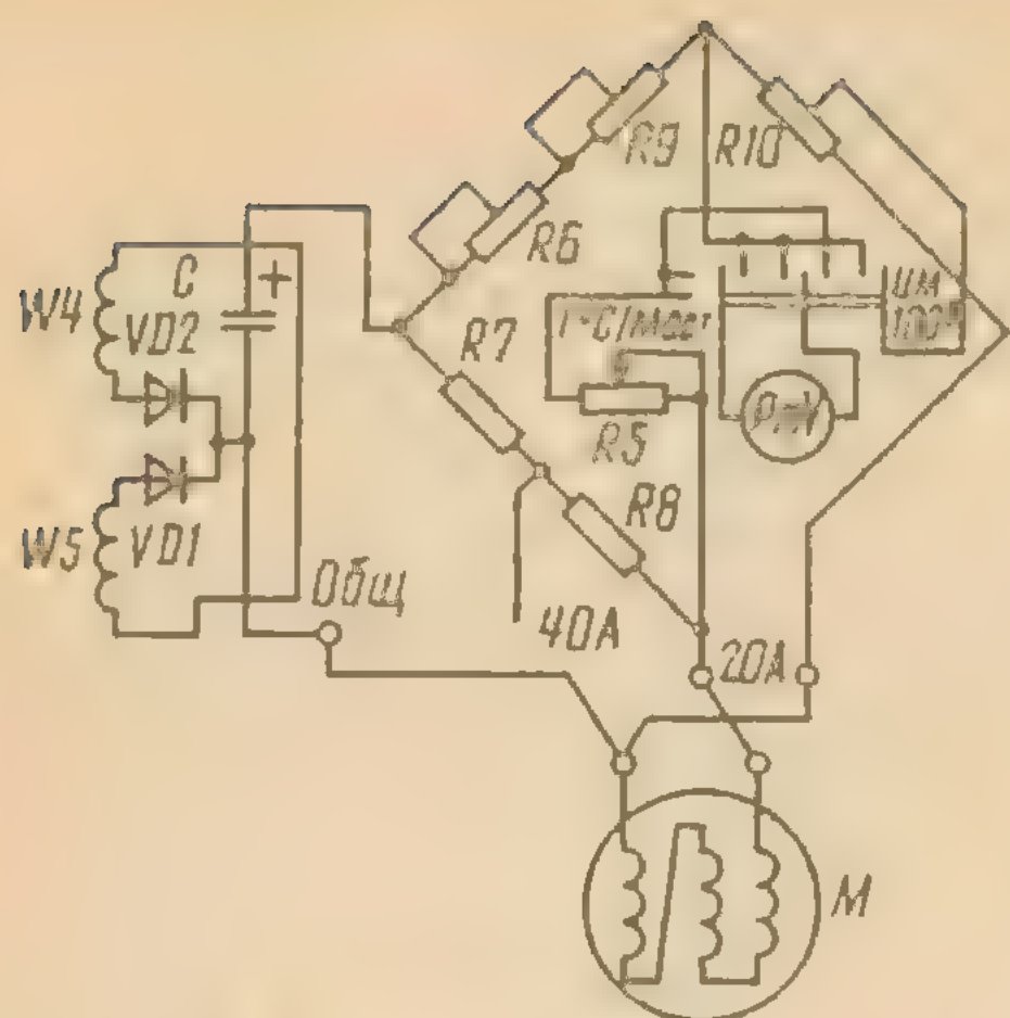
Рис. 27.7. Схема моста, образуемого элементами стенда и обмоткой электродвигателя.
